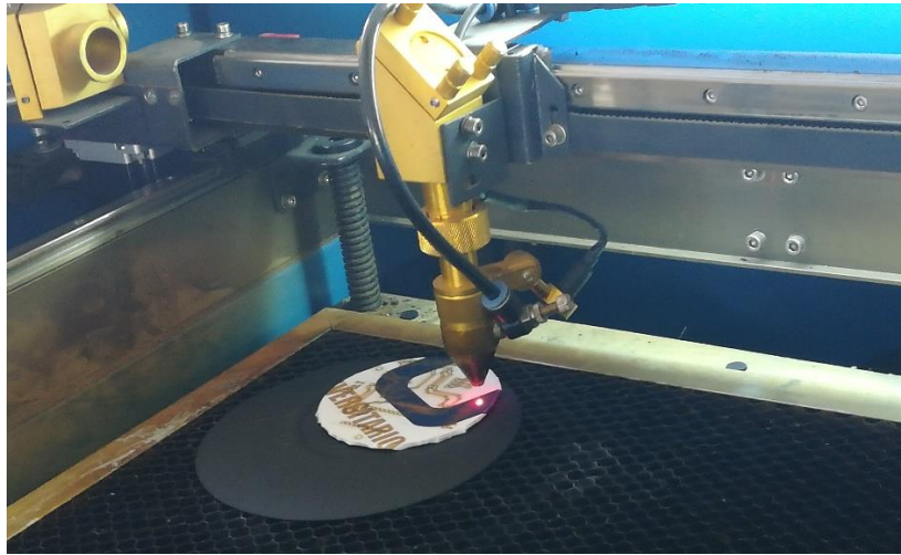
Ilustración 52. Fabricación de PCB en cortadora laser.
