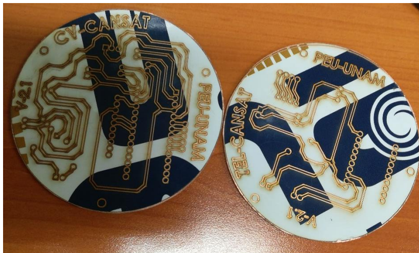
Ilustración 53. PCBs después del corte laser
