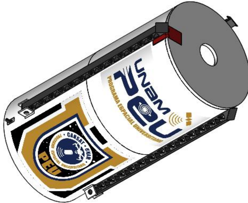
Ilustración 41. Satelite Enlatado diseñado en SolidWorks
