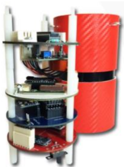
Ilustración 11 Cansat AEM-1 con su módulo de potencia, telemetría y computadora de vuelo.
